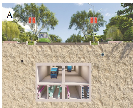
Рис. 1. Типы интегрированных городских трубопроводных коридоров: А – инженерные коридоры, интегрированные в подземные транспортные магистрали; Б – комплексные инженерные коридоры с отдельным доступом.
