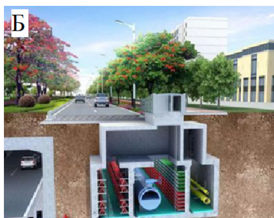
Рис. 1. Типы интегрированных городских трубопроводных коридоров: А – инженерные коридоры, интегрированные в подземные транспортные магистрали; Б – комплексные инженерные коридоры с отдельным доступом.
