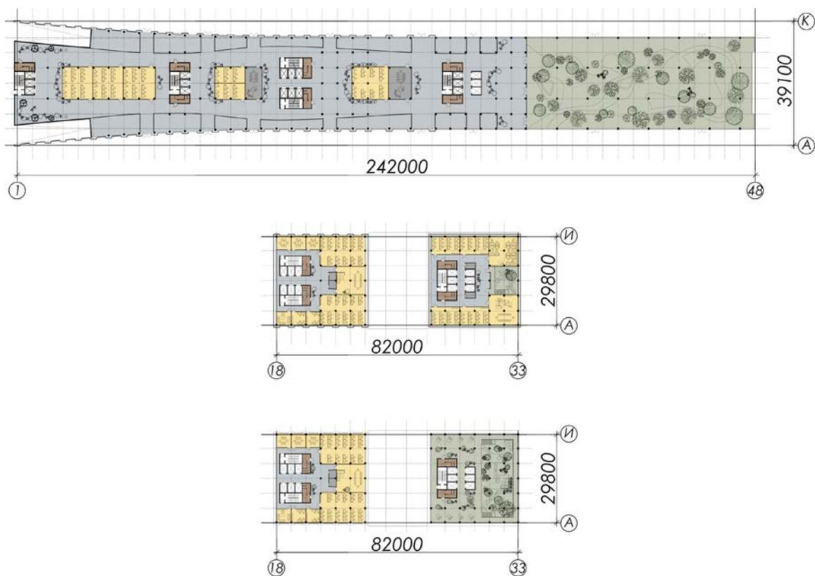
Рис. 4. Схема планировки общественного здания: а – схема плана 1-го этажа; б – схема плана типового этажа; в – схема плана на уровне «небесного сада»
