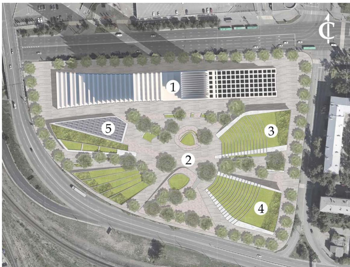
Рис. 2. Схема генерального плана: 1 – проектируемое здание; 2 – благоустроенная площадь; 3, 4 – павильоны под «зелёным куполом»; 5 – крытый амфитеатр
