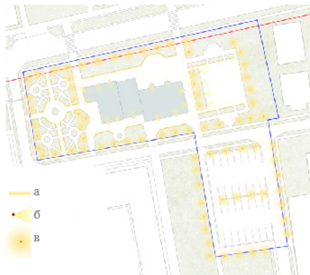
Рис. 4. Схема плана освещения территории комплекса мечети: а – линейные источники; б, в – точечные источники
