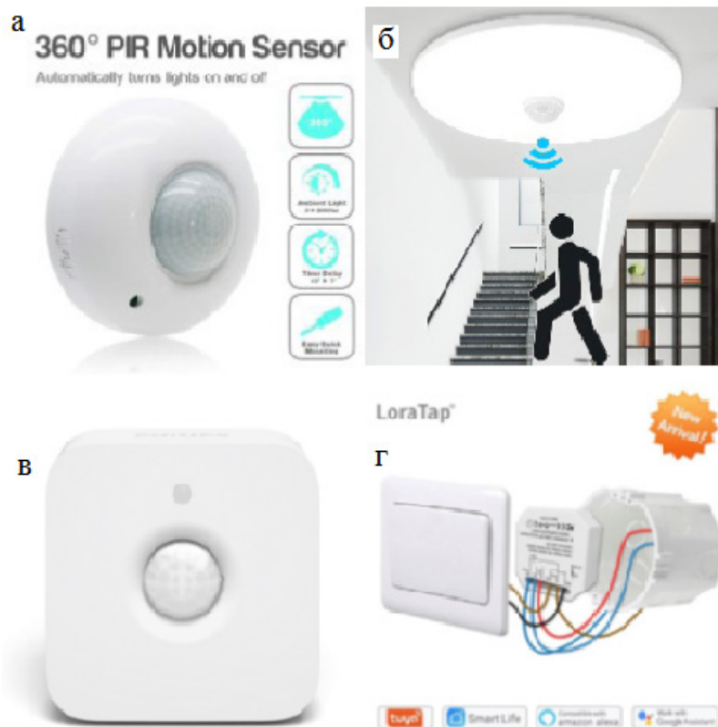
Рис.7. Устройства и датчики: а – пирозлектрический инфракрасный датчик; б – датчик движения; в – датчик освещенности; г – Wi-Fi переключатель
