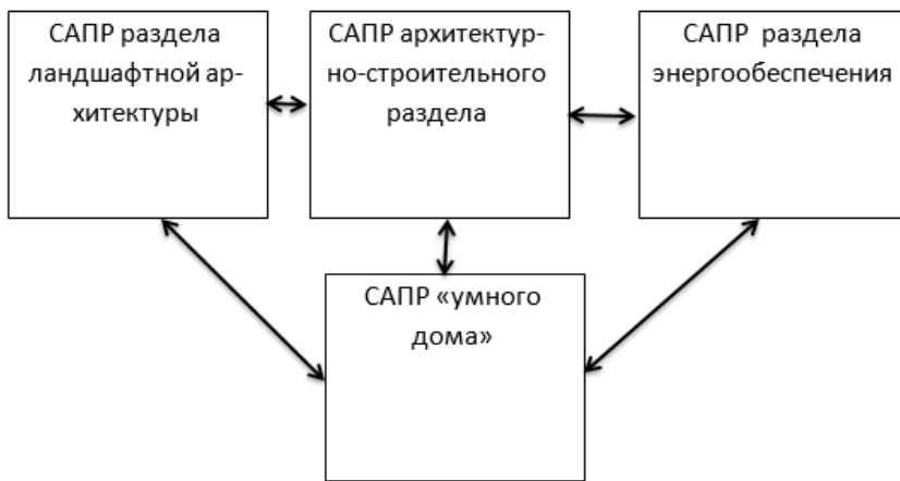
Рис.3. Функциональная схема САПР по разработке конструкторской документации для экопоселений
