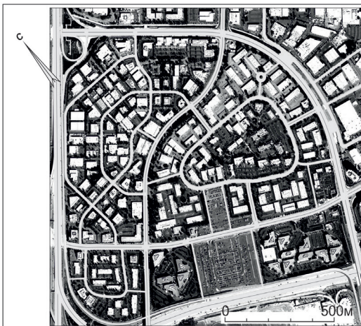
Рис.4 Научно-производственный высокотехнологичный комплекс в округе Ориндж в Калифорнии, США, формируется небольшими предприятиями в озелененной среде. Криволинейная планировка придает живописность застройке. а - схема генплана (фрагмент); б, в - виды застройки
