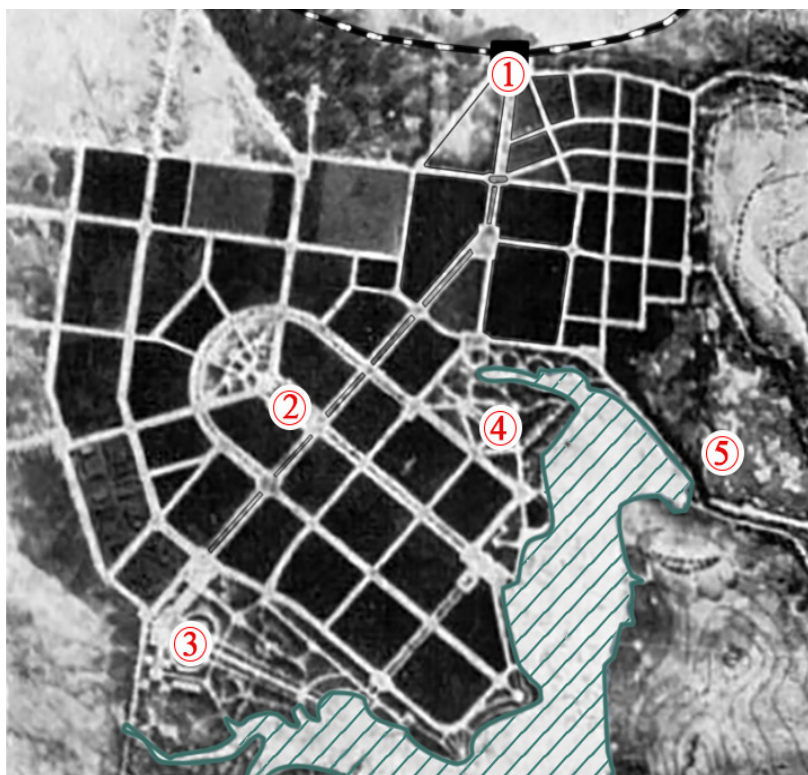
Рис. 1. Генеральный план города Ревды, разработанный в 1938 году архитектором Д.П. Гаузнером [9]: 1 – привокзальная площадь; 2 – главная административная площадь; 3 – спортивный парк со стадионом; 4 – рекреационное пространство; 5 – метизно-металлургический завод
